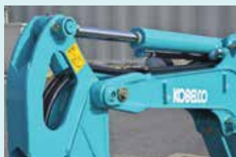
Slangen bakcilinder lopen door graafarm
